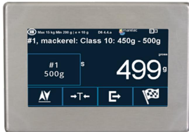
La báscula de paquetes le permite registrar paquetes o productos individuales en una base de datos. No es necesario tarar la báscula con una caja o bandeja vacía cuando puede vincular el peso de tara del paquete a sus productos de forma remota en el PC.
