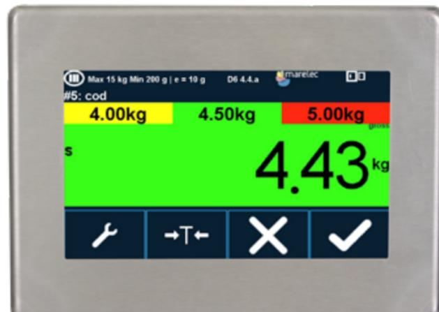
Fabricado específicamente para funcionar como estación de corrección de errores en instalaciones de envasado, este módulo permite al usuario establecer los límites (peso y número de artículos) de un paquete.
