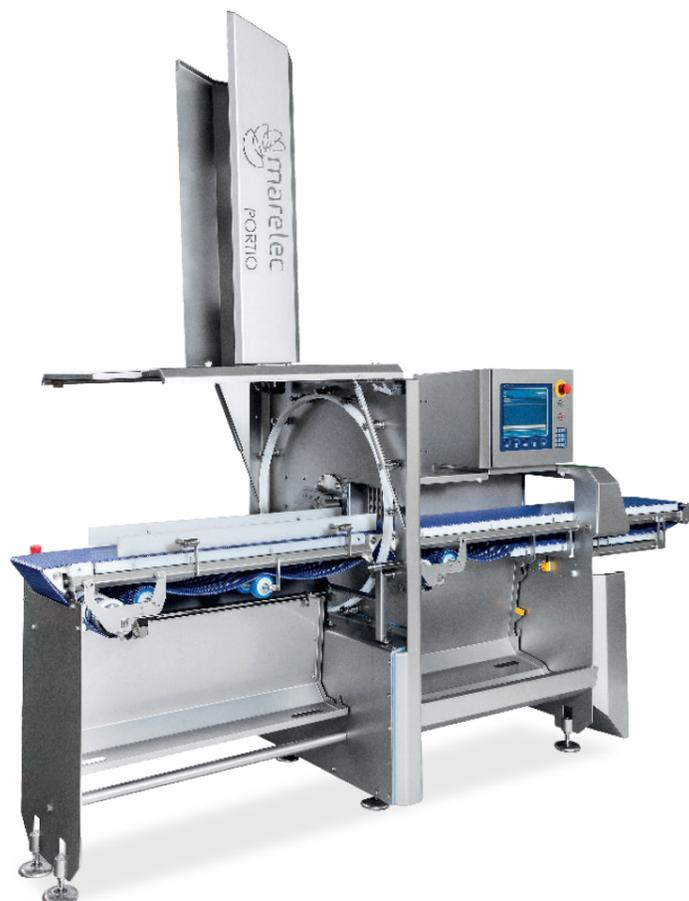
Модель PORTIO 1F сочетает в себе компактный дизайн с проверенной технологией сканирования и нарезки, используемой в модели PORTIO 1. Подходит для нарезки продукта длиной менее 700 мм. В основном модель PORTIO 1F используется для нарезки рыбы или куриного филе на порции с фиксированным весом или фиксированной толщиной, в тех случаях, когда не требуется держатель продукта.
