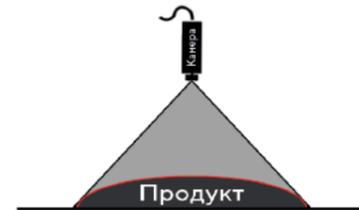
В модели PORTIO 3 используется три камеры сканирования - одна сверху и две по бокам. Данная модель предназначена для работы с округлым продуктом, наличие 3х камер позволяет полностью отсканировать продукт, без слепых пятен. Типичные продукты для нарезки на данной модели PORTIO: отруба красного мяса, деликатесная мясная продукция, целая тушка рыбы, филе индейки.
