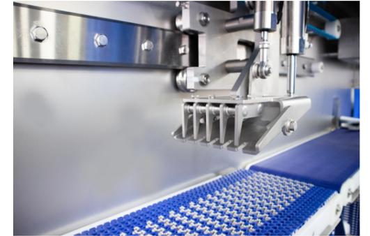
Während der Greifer dafür sorgt, dass sich die Teilstücke nicht nach hinten bewegen, verhindert der Oberhalter, dass sich die Produkte auf dem Zufuhrband seitlich bewegen. Die Kombination aus Greifer und Oberhalter garantiert präzise Schnitte mit festem Gewicht und hoher Schnittqualität, bereit für die Präsentation in einer Verkaufsverpackung.
