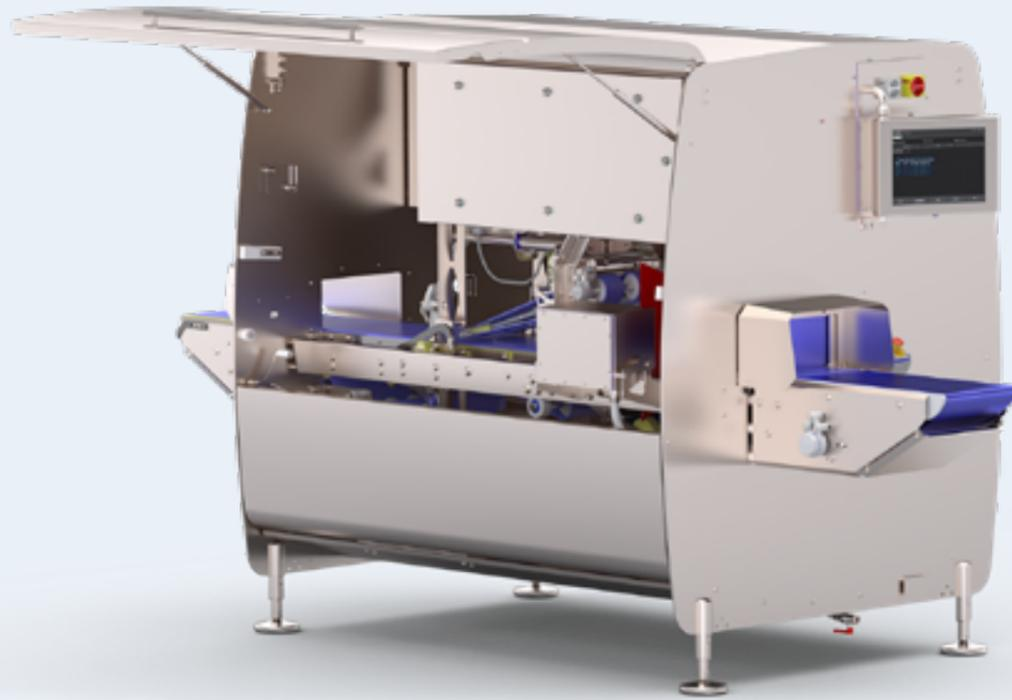
La PORTIO 12 tiene, además de la cámara superior, dos cámaras laterales adicionales para los productos más redondeados, así como la función de alterar el ángulo de la cuchilla en relación con la posición vertical, de 0.º a 30.º o a 45.º. Cortar con ángulo da un aspecto natural a las porciones o un mayor tamaño en plato.
