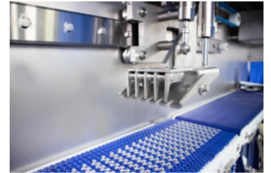
抓爪器可确保原料产品不会向后移动，而顶部保持架可防止产品在进料部分侧向移动。抓爪器和顶部保持架的组合使用将保证切割出高切割质量和高切割精度的产品，以随时准备用于零售包装。
